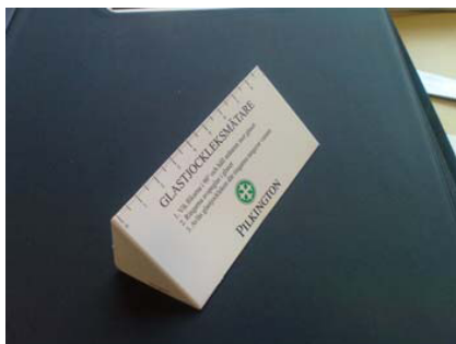
Figur 10. Med hjälp av en glastjockleksmätare kan samtliga glasrutors tjocklek i ett monterat fönster fastställas okulärt.
