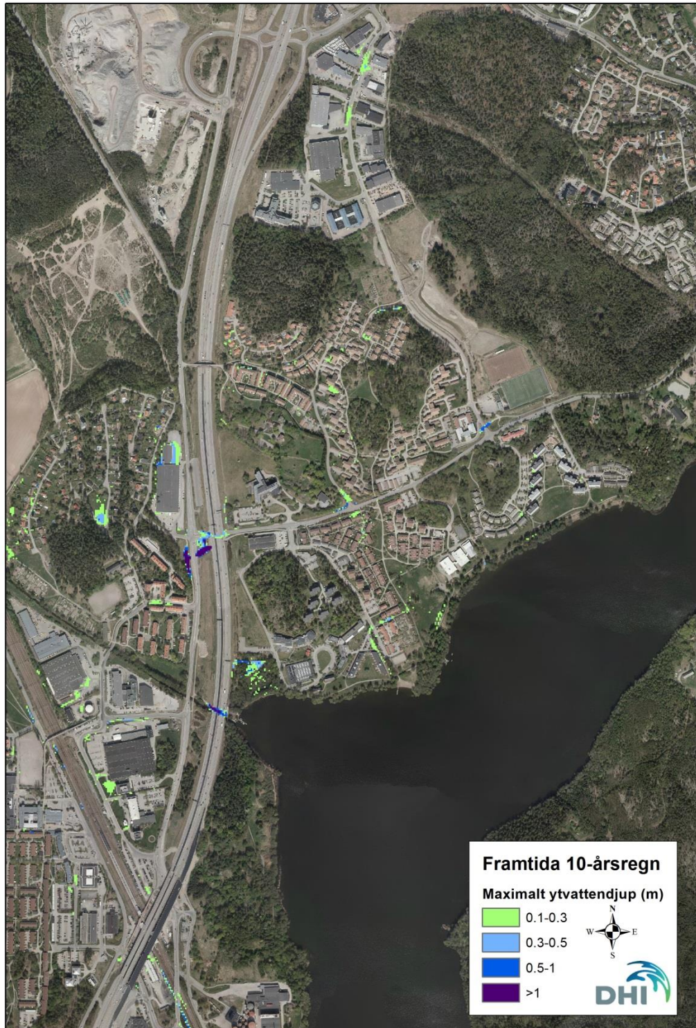
Kartbild 12. Maximala översvämningdjup i norra Rotebro vid ett framtida skyfall med 10 års återkomsttid.
