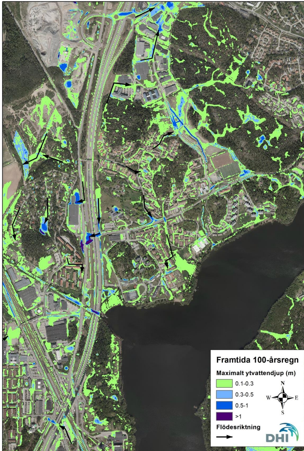
Kartbild 1. Översvämningsdjup och huvudsakliga flödesvägar i norra Rotebro vid ett framtida skyfall med 100 års återkomsttid.
